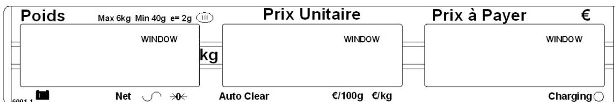
L'écran du **Poids** a une flèche qui indique lorsque la balance est à zéro ou si la balance est entrain d'afficher le poids net (si une valeur de tare a été rentrée). Elle indique également lorsque la balance est stable.
