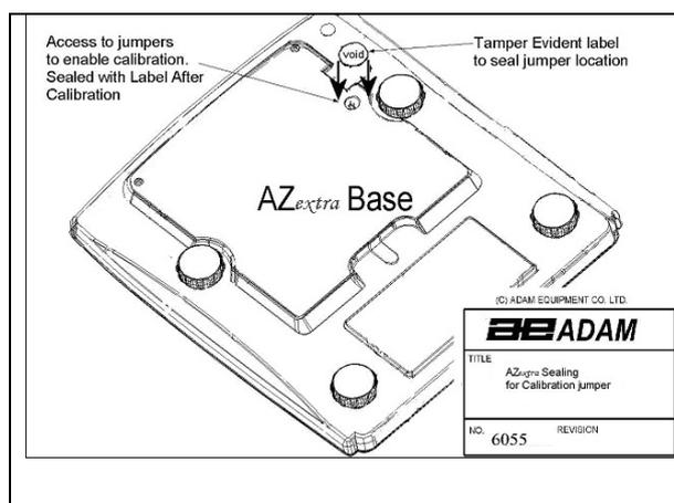
Le calibrage de la balance AZ<sub>extra</sub> est accompli en retirant l'étiquette de la base de la balance laquelle couvre un trou à travers lequel le circuit interne PCB peut être atteint. Si votre balance n'est pas fournie avec ce trou, vous devez alors casser le plomb de sécurité et enlever la partie haute du boîtier pour accéder au circuit interne. Voir l'illustration sur le plomb de sécurité ci-dessous.
